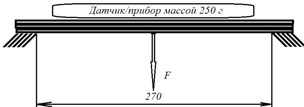
Рис. 3. Схема лабораторного стенда
