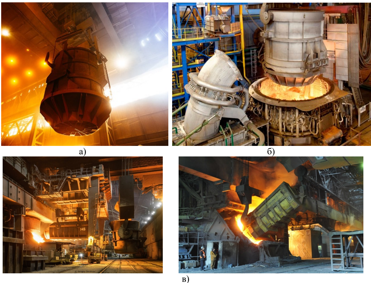
Рис. 1. Бадья перед загрузкой (а) и над электродуговой печью (б), завалка металлолома в конвертер (в, г)
